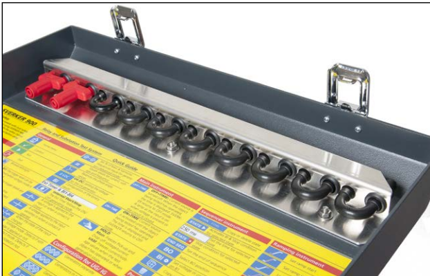
盖子里面有十个固定在支架上的跳线、一个触摸屏、一支笔和快速指南。
